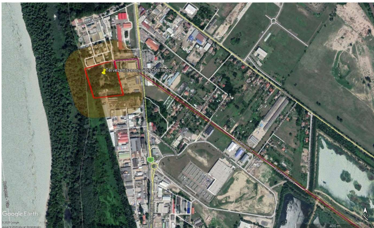
15. ábra: A levegővédelmi hatásterület a telep területén 102 méter az ingatlan határaitól számítva, a vezeték mentén 10 méter széles sáv
