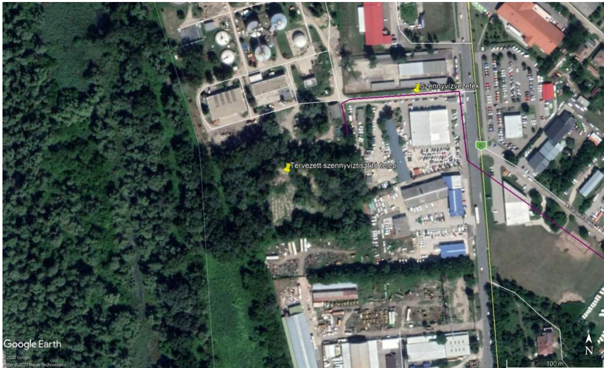
1. ábra: A tervezett szennyvíztelep helye és a nyomóvezeték (lila vonallal) becsatlakozása
